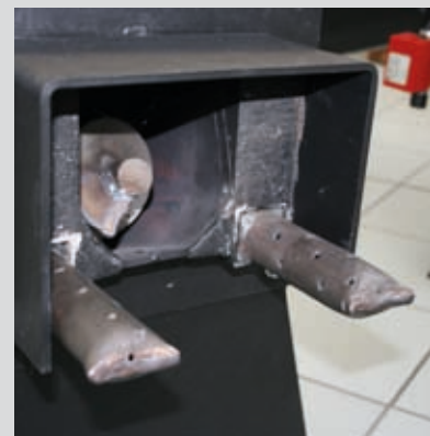
Syöttöruuvi jossa ensiöilmaputket
