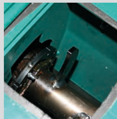
Siirtoruuvipäässä murskain tikkujen katkomiseen
