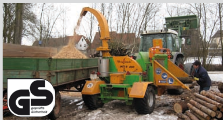
Heizohack – käsisyöttöiset hakkurit jopa 30–40 cm:n rungoille.
