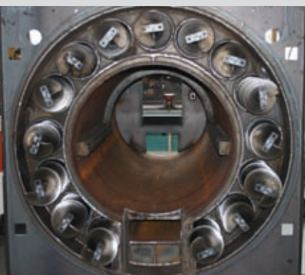
Tukkeutumaton tuubirakenteinen lämmönvaihdin ja nuohousruuvit
