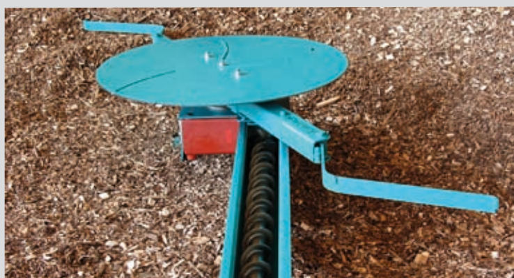
Kestävä 1–7 metrin nivelvarsipurkain, joka kuljettaa polttoainetta luotettavasti
