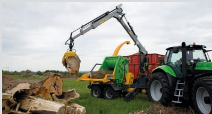
Heizohack kuormainsyöttöinen hakkurimme halkaisijaltaan jopa 50–80 cm:n rungoille
