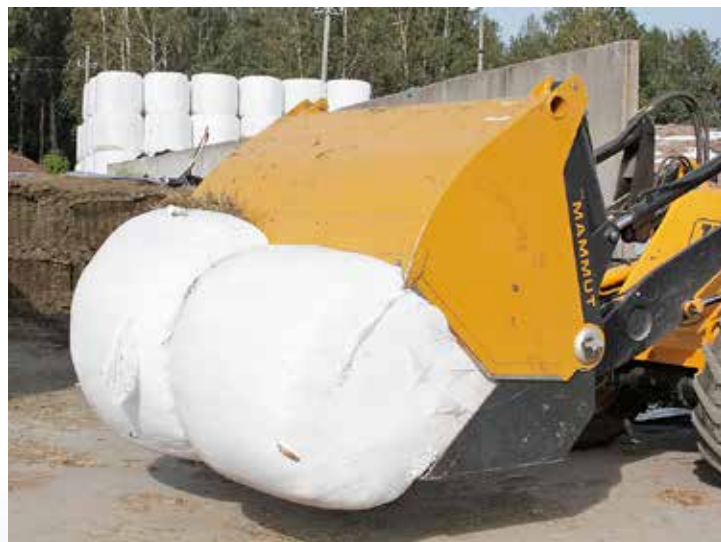
↑ 240 cm leveällä kauhalla pystyy kuljettamaan ja leikkaamaan jopa kahta pyöröpaalia samanaikaisesti.
